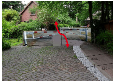
Bild 13: Nördlicher Anschluss – 5. Absperrvariante (Quelle: Eigene Aufnahme 2017, bearbeitet)
