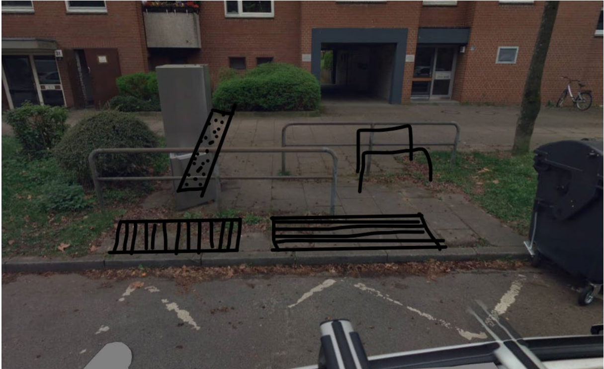
Erich-Ziegel-Ring 31 West - Blindenleitsystem, 0-6 cm-Absenkung, Umlaufsperrern entfernen, Fahrradabstellbügel
