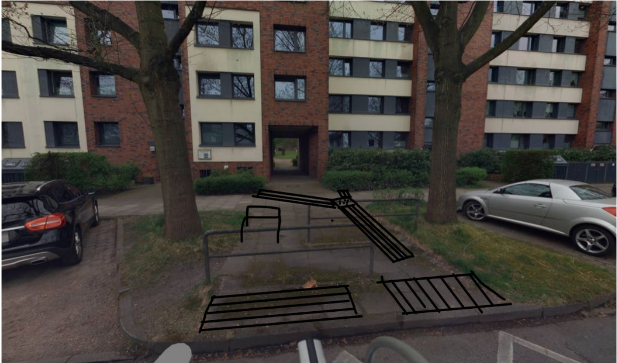
Borchertring 35 - Blindenleitsystem, 0-6 cm-Absenkung, Umlaufsperrn entfernen, Fahrradabstellbügel
