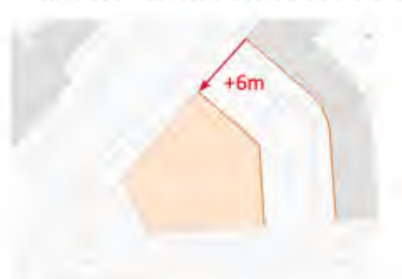
Variante 4: Abstandsvergrößerung Fassade Planung (Nordost) zur Bestandsbebauung (+6m)
