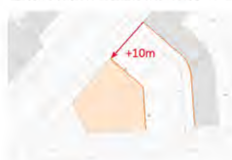
Variante 5: Abstandsvergrößerung Fassade Planung (Nordost) zur Bestandsbebauung (+10m)
