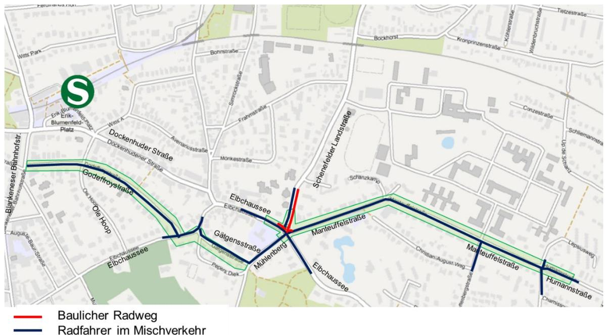
Abbildung 18 Verlauf und Art der Radverkehrsführung im Untersuchungsgebiet
