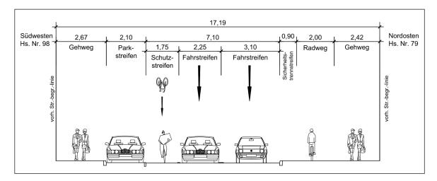
Alternativ wurde Variante 2 erarbeitet, bei der der Radverkehr entgegen der Einbahnstraße auf einem baulichen Radweg mit 2,00 m Breite im Seitenraum geführt wird. Der Einmündungsbereich zur Lübecker Straße ist umzugestalten und eine Anbindung an den angeordneten Radweg herzustellen. In dem erforderlichen Sicherheitstrennstreifen in der Gütherstraße wird die öffentliche Beleuchtung aufgestellt.
