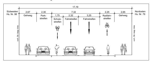
Durch den Entfall eines Kfz-Fahrstreifens und Berücksichtigung eines Schutzstreifens mit 1,75 m Breite können ReStra-konforme Seitenräume für die Fußgänger mit 2,65 m Breite sichergestellt werden. Bei dieser Variante ist einseitig ein Längsparkstand mit 2,30 m Breite zu realisieren.
