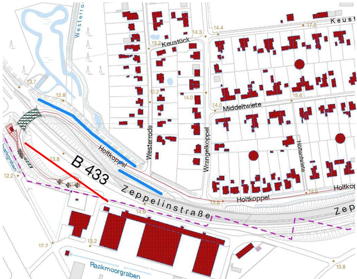
Neben den täglichen Verkehrsmengen (Straße Holtkoppel nach Angabe des PK 34: 2500 Kfz/24 h) wurden Parkplätze und Außengastronomieflächen als Flächenschallquellen digitalisiert, außerdem wurden zweimal drei Punktschallquellen als Dauerschallquellen mit einer Dauerschallleistung von 90 dB(A) zur Simulation von Motorläufen mit hohen Drehzahlen angesetzt.
