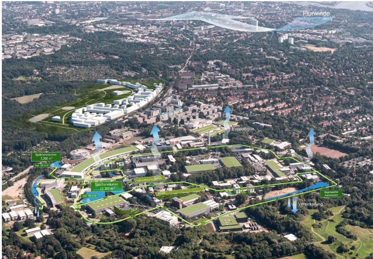
Bild 5 Regenwasserkonzept auf dem Forschungscampus DESY. Copyright DESY Hamburg und CONSULAQUA Hamburg
