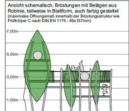
Plattform bei 2,70m Höhe mit Blätterbrüstung, mit Leiterausstieg zum Rundsteg unterhalb und Übergang zur Balancierstrecke, Rundsteg unterhalb der Plattform bei 1,35m Höhe, mit Leiterausstieg vom Boden
