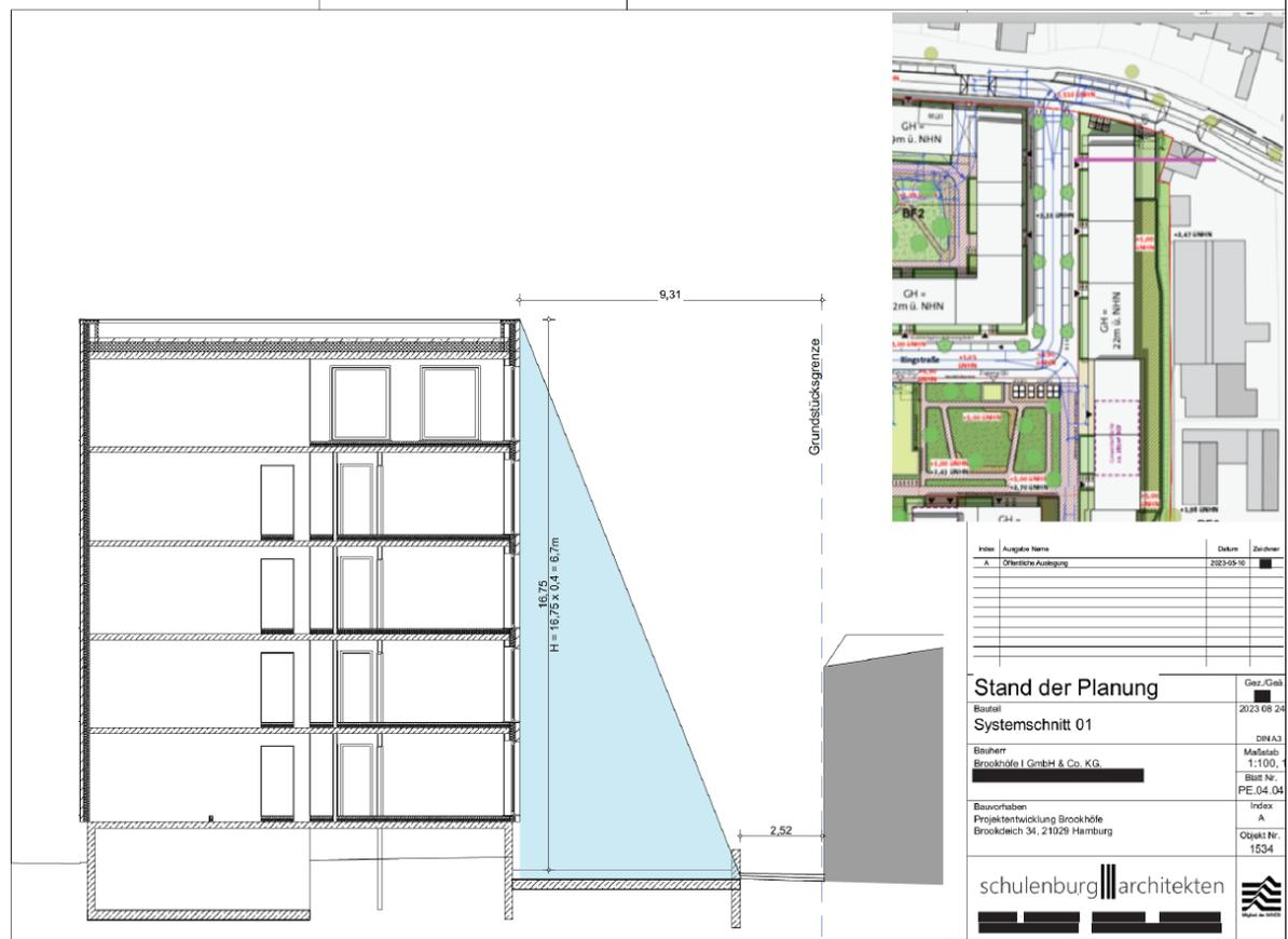
2. Schnitt entlang des Grenzgrabens mit Darstellung der unterschiedlichen Abstände der Neubebauung zum Grenzgraben
