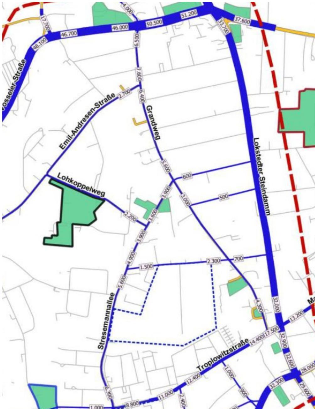
Abb. 4: Auszug aus Verkehrsanalyse – DTVw-Querschnittsbelastungen (Kfz/ 24h) auf S. 22, Abb.18 (Quelle: Büro SBI)
