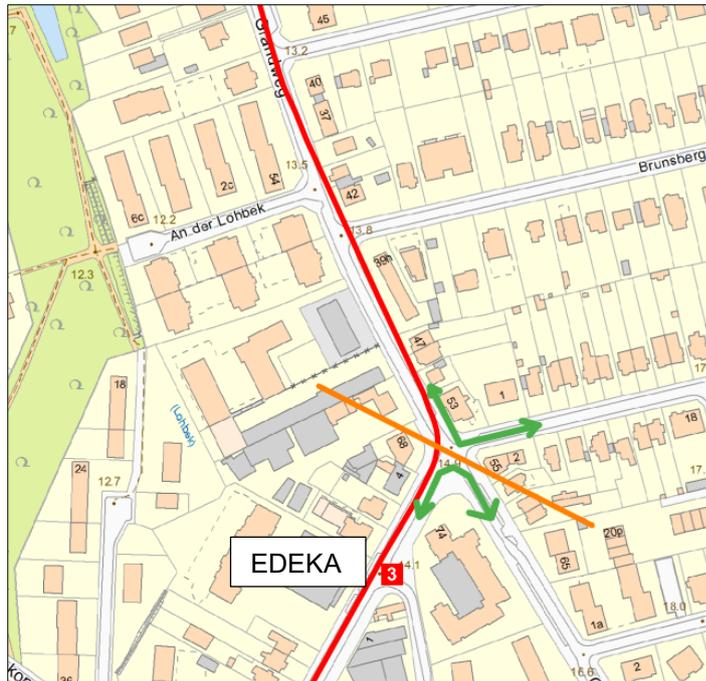
Abb. 6: Ausrichtung der Diagonalsperre Variante 2 (Vorzugsvariante/Planungsansatz), Kartengrundlage Geoportal Hamburg
