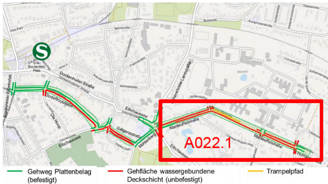
Abbildung 10 Verlauf und Art der Gehwegbefestigung im Untersuchungsgebiet (Quelle: Geobasiskarten Hamburg, Stand 2018, eigene Bearbeitung)
