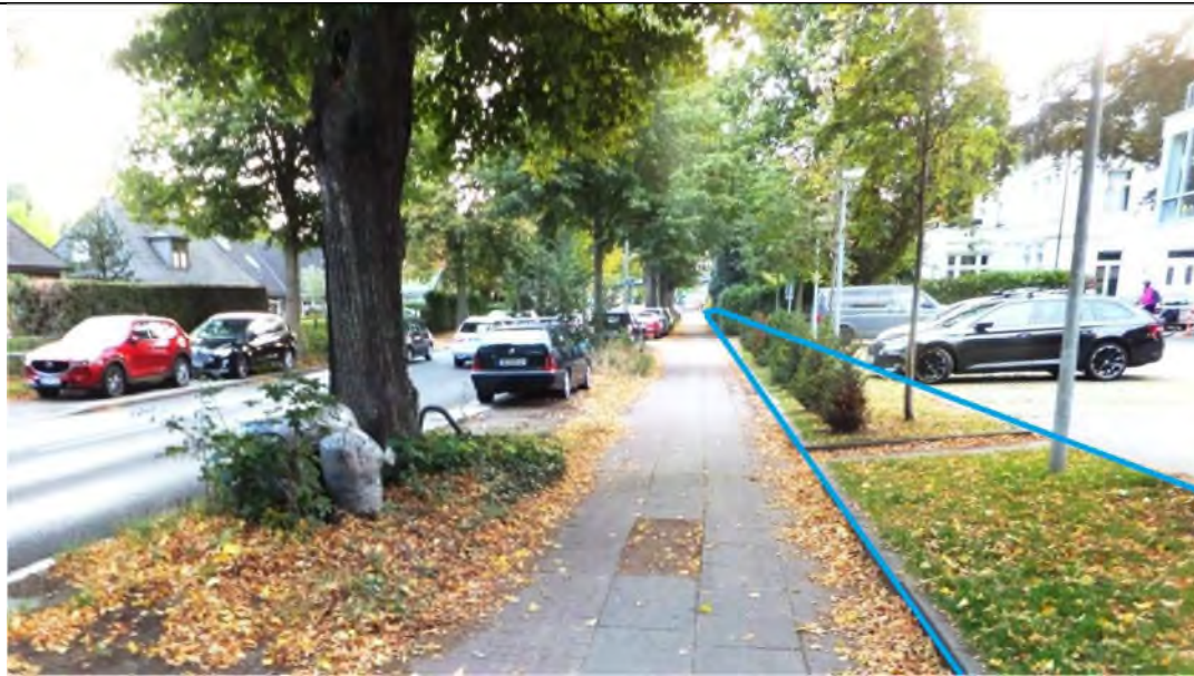
Abbildung 4: Mögliche Profilaufweitung (blaue Linien) vor Nr. 61 hätte Entfernung des privaten Abstandsgrüns zur Folge. Ein Erhalt der höherwertigen Alleebäume ist zu bevorzugen. Ein Ersatz auf Privatgrund ist zu prüfen.
