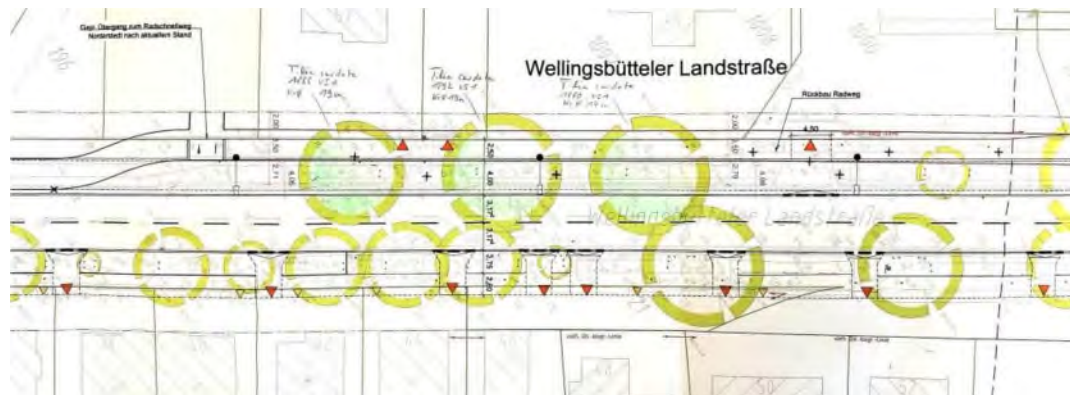
Abbildung 3: Variante 4 mit Profilaufweitung der Nebenflächen im Bereich der Grundstücke Nr. 57-61 zwecks Erhalts der nordwestlichen Alleebaumachse, Plangrundlage zur Vorabstimmung.
