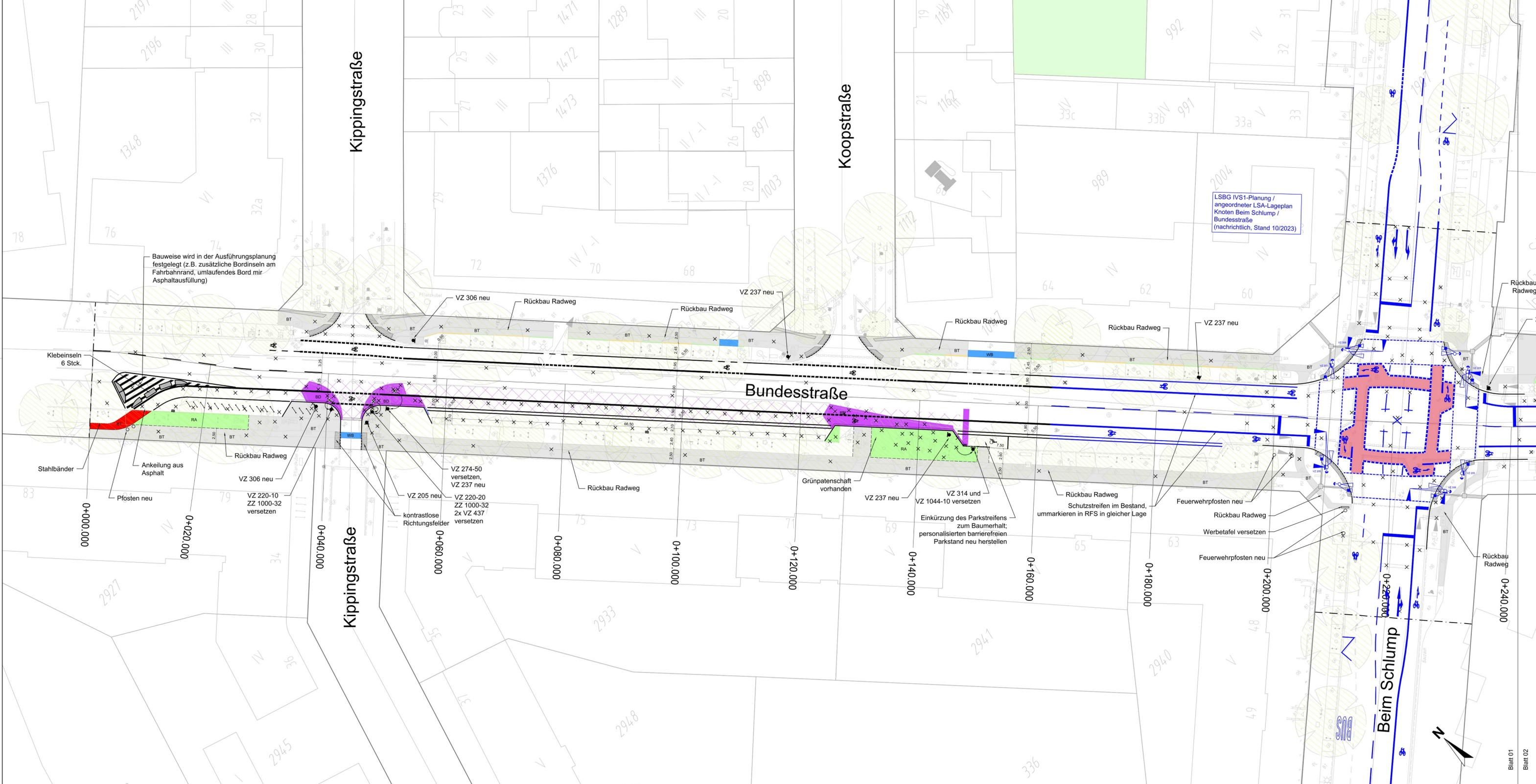
Bauweise wird in der Ausführungsplanung festgelegt (z.B. zusätzliche Bordinseln am Fahrbandrand, umlaufendes Bord mit Asphaltausfüllung)
