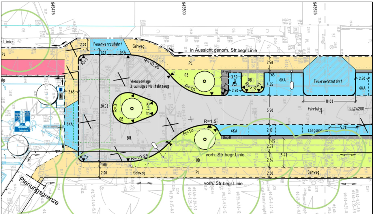
Abbildung 4: Variante 1 - mittig angeordnete Wendeanlage
