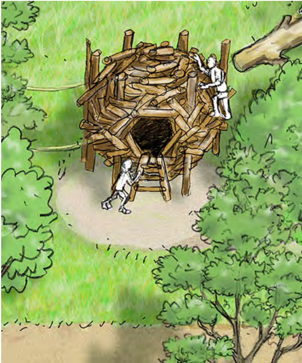
Illustration | Konstruktion aus Robinienholz, Fallhöhe maximal 3m
