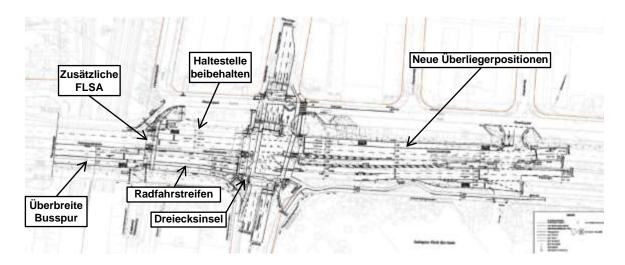
5. Wie vor, jedoch Verbreiterung und Verlängerung der Trenninsel im Ostast Hebebrandstraße, Führung des Radfahrers im Ostast bis zur Buswendeposition auf einem Radfahrstreifen (s.u.).
