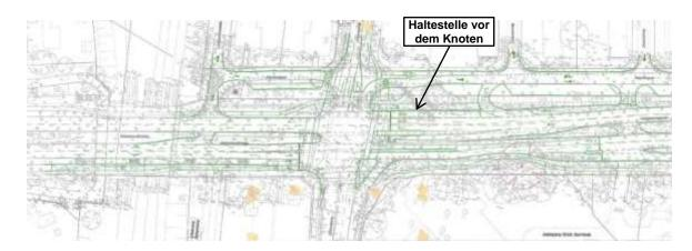
4. Einbau einer Dreiecksinsel von der Hebebrandstraße West zum Rübenkamp Süd, zusätzliche Fußgängersignalanlage Hebebrandstraße beim S-Bahnzugang, Radfahrer in überbreiter Busspur (s.u.).
