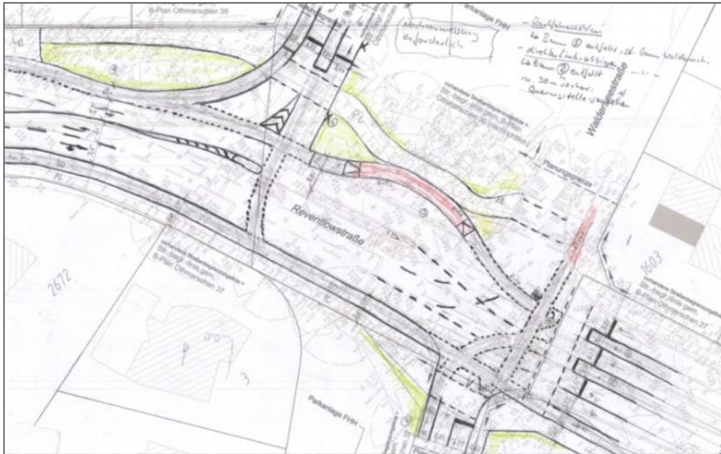
Abb. 8: Abschnitt 2, Variante 1 Direktes Linksabbiegen Reventlowstraße Süd
