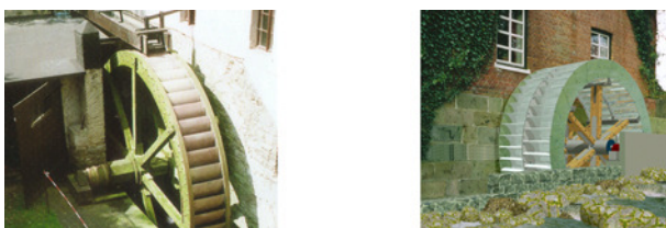
Abb. 1: Wasserrad oberschlächtig (li.) und mittelschlächtig (re.) 3)
