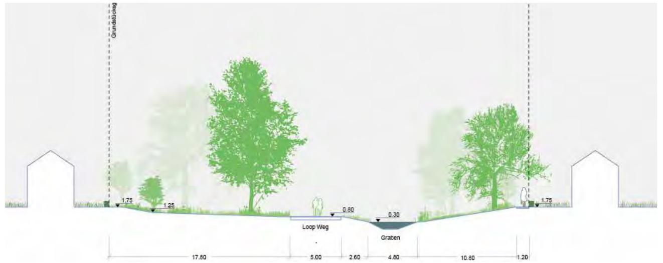
71 Abb.41: Schnitt DD: Systemschnitt Grüner Loop
