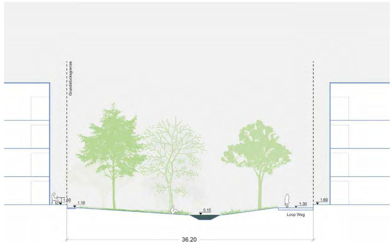
71 Abb.70: Systemschnitt Entwässerung Grüner Loop
