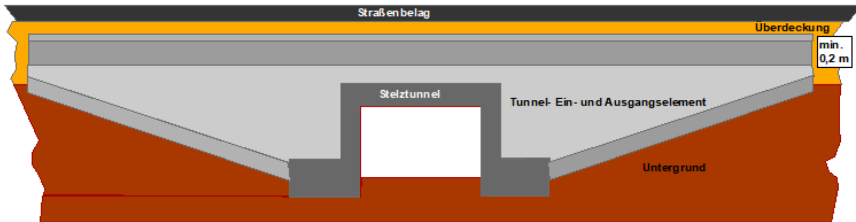
Abb. 3.3.3: Einbauprinzip des Stelztunnelsegment des Herstellers Zieger
