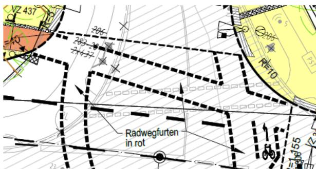
**LSBG:** Die Aufstelltasche wurde überarbeitet und die Haltelinie für den linksabbiegenden Radfahrer wurde eingeplant. In der ERA 2010 steht, dass das Linksabbiegen mit indirekter Radverkehrsführung im Kreuzungsbereich eine während des Wartens geschützte Aufstellmöglichkeit erfordert. Das Radfahrersignal für den linksabbiegenden wird auf die östliche Seite der Einmündung versetzt.
