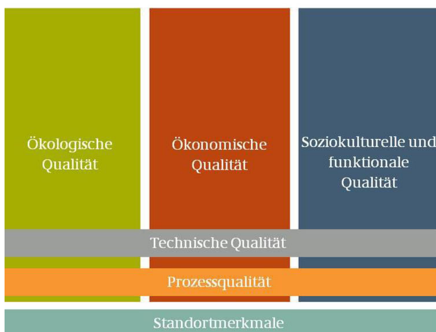
Abbildung 21: Dimensionen der Nachhaltigkeit mit Querschnittsqualitäten gemäß BNB. Herausgeber: Bundesministerium des Innern, für Bau und Heimat (BMI).
