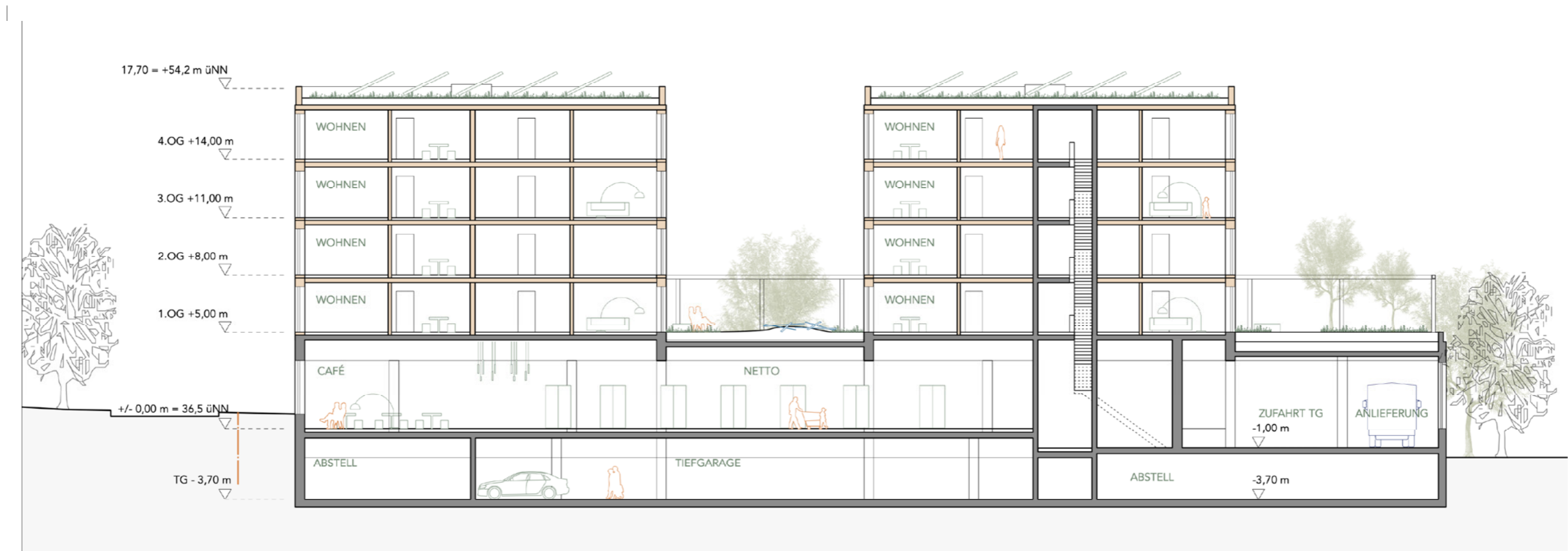
ANSICHT SÜD/ WEUSTHOFFSTRASSE_SCHNITT ENTWURFSELEMENTE_HÖHENLAGEN_
