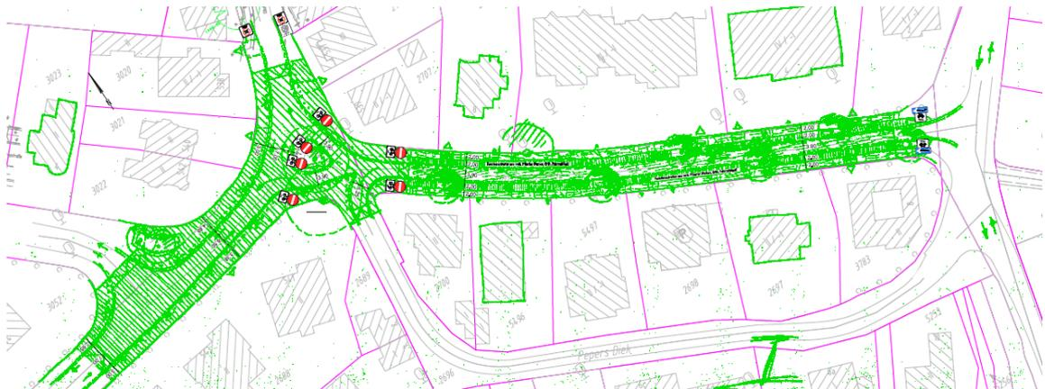
Abbildung 33 TBA3 Variante 3a – Elbchaussee als Platz und Gätgensstr. mit Multifunktionsstreifen
