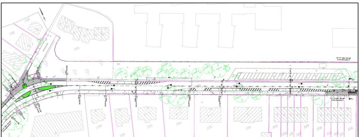
Abbildung 48 TBA6 Variante 2 – optische Fahrbahneinengung
