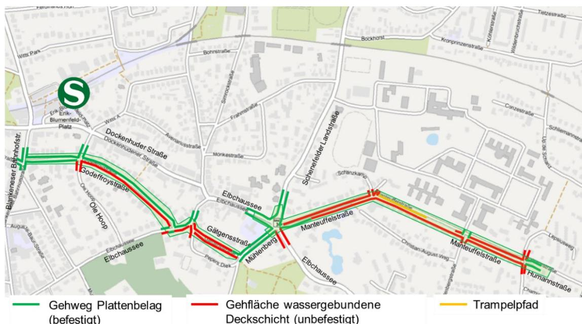
Abbildung 18 Verlauf und Art der Gehwegbefestigung im Untersuchungsgebiet
