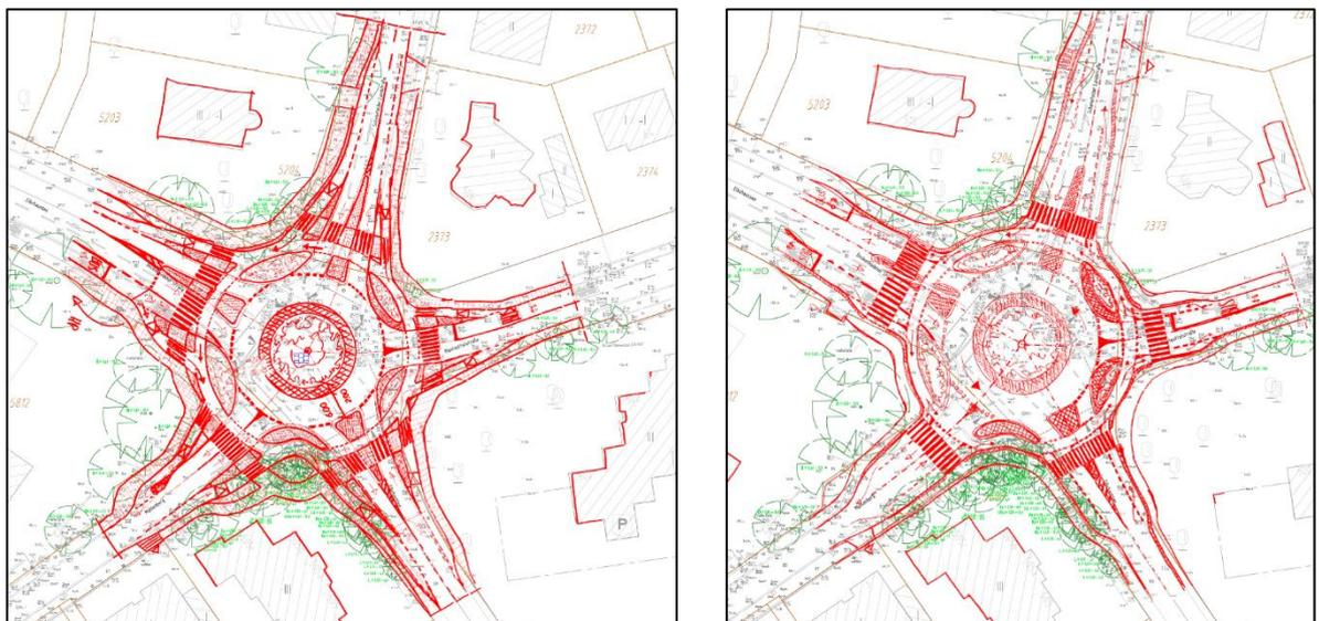
Abbildung 38 TBA4 Variante 1a (links) & 1b (rechts) – Kreisverkehrsplatz
