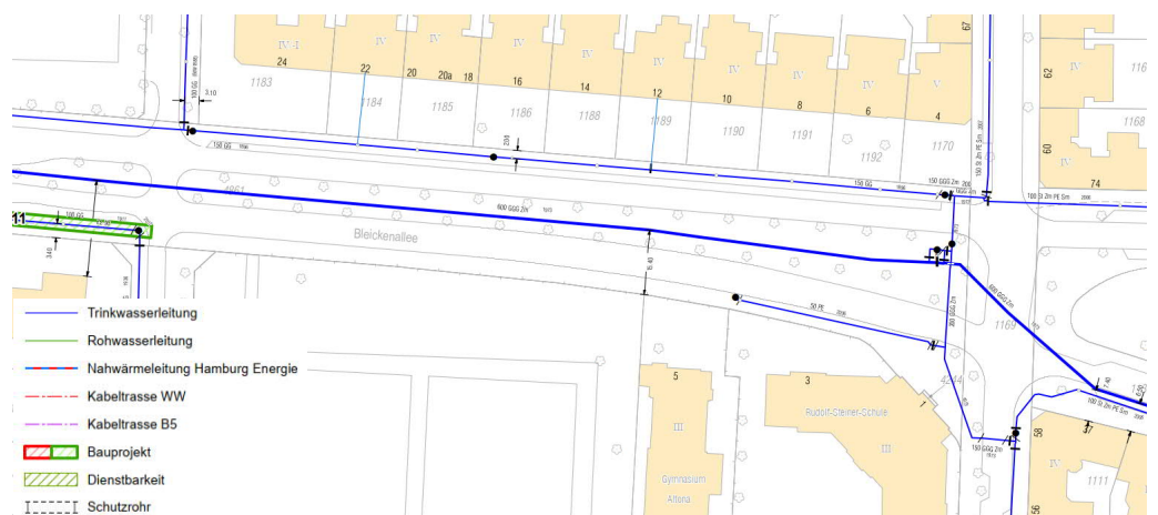
Abb. 6 Hamburgwasser– „Anlage 1“ (Trinkwasserleitungen)
